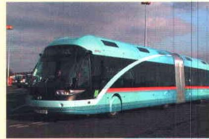
El sistema de rueda motor permite acoplar a futuro nuevas tecnologías de tracción actualmente en fase de desarrollo, como la tracción híbrida o la pila de hidrógeno.
